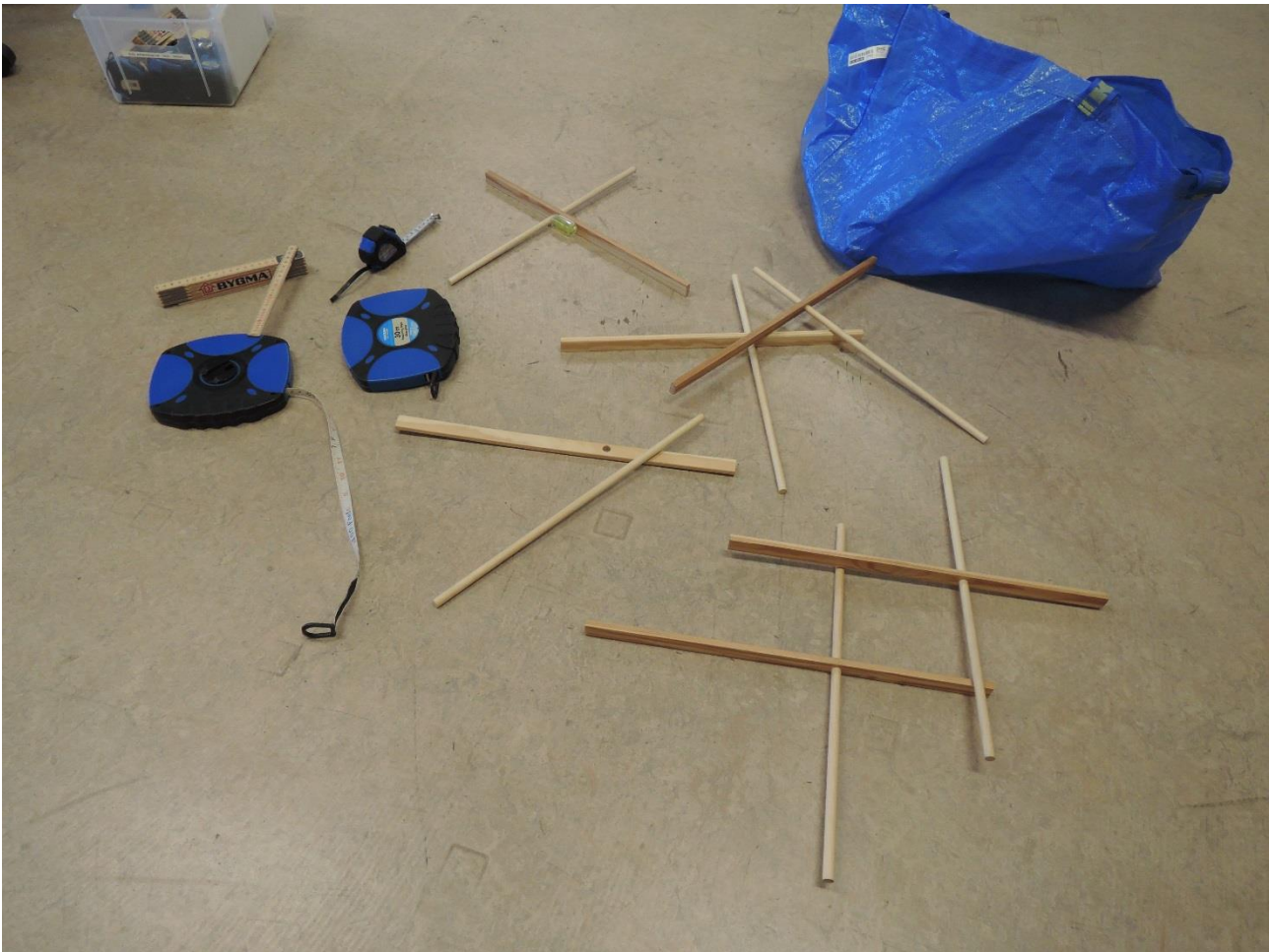
Figur 1: 6 stk Jacobs stave samt "tommestok" og målebånd. Jacobs staven midt i billedet er afskilt i sine 2 dele. En rundstok, som kan forskydes i en anden pind med hul i. Rundstokken bevæger sig stramt i hullet, så en indstilling kan fastholdes.
